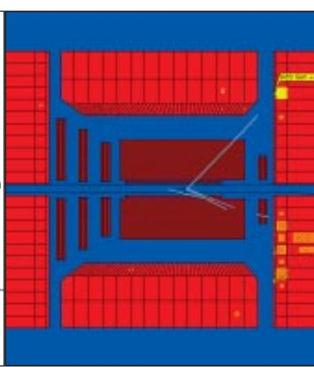
RapGap – ein „diffraktives“ Ereignis bei ZEUS (rechts: Teilchenspuren im Detektor, links: gemessene Energie in Abhängigkeit von der „Rapidity“). Hier ist der Protonenrest (p) im linken Teil der Grafik nicht mehr zu sehen – er sollte bei einem Wert von ca. 7 liegen. Außergewöhnlich ist, dass zwischen dem Teilchenbündel von dem herausgeschlagenen Quark (X) und dem Protonenrest keine weiteren Teilchen zu finden sind. Diese „Lücke“ in der Rapidity („RapGap“) ist ein Merkmal der Diffraction.
