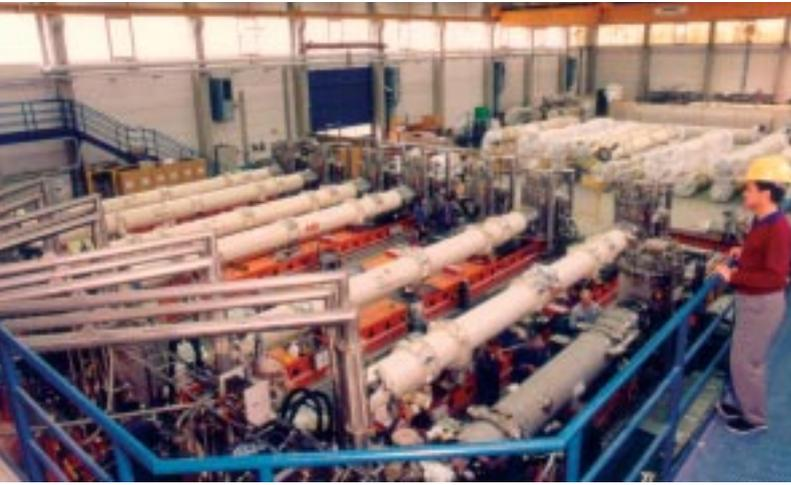
**Test der supraleitenden Protonenmagnete für HERA.**
