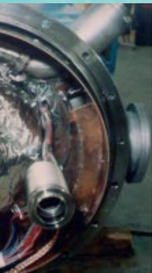
**Blick in den „Kopf“ eines supraleitenden Magneten mit seinen technisch höchst anspruchsvollen Anschlüssen und Verbindungen.**
