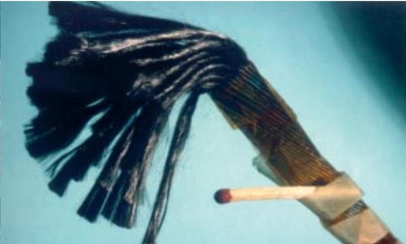
28 000 Filamente enthalten die supraleitenden Kabel, aus denen die Spulen der Protonenmagnete gewickelt sind.
