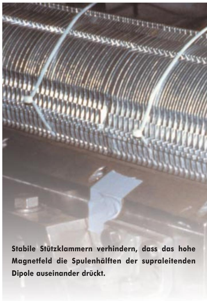
Stabile Stützklammern verhindern, dass das hohe Magnetfeld die Spulenhälften der supraleitenden Dipole auseinander drückt.
