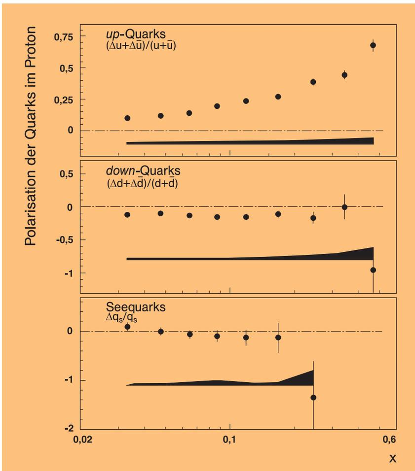
**Präzise vermessen: die Polarisation der *up*- und *down*-Quarks sowie der Seequarks im Proton. Die Spins der *up*-Quarks zeigen bevorzugt in Richtung des Protonenspins, die *down*-Quarks entgegengesetzt. Die Seequarks tragen kaum zum Spin des Protons bei. (Die schwarzen Bänder geben die systematischen Fehler der Messung an.)**
