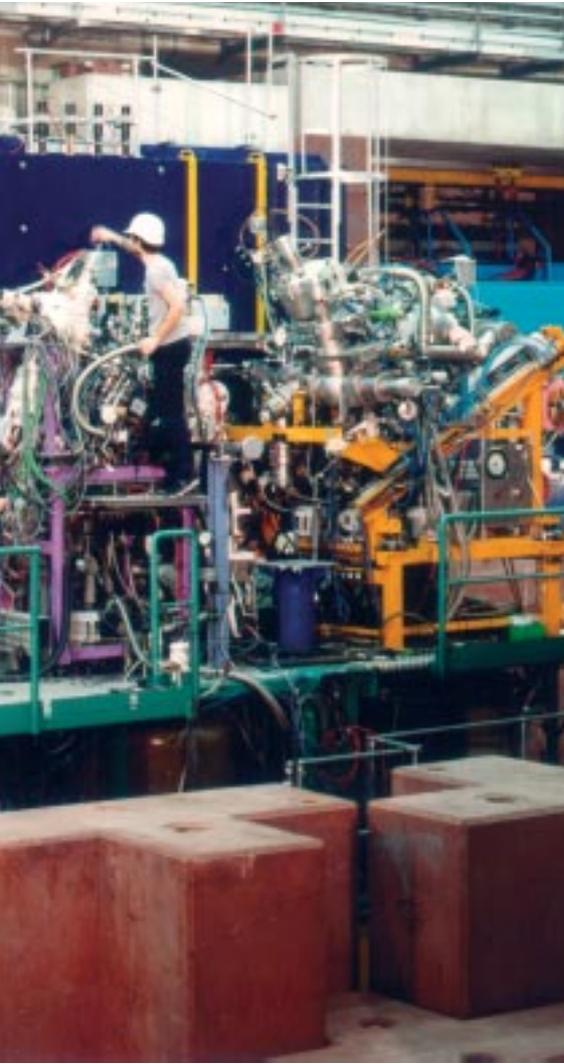
**Der HERMES-Detektor in der HERA-Halle Ost: im Vordergrund der Bereich des Gas-Targets, dahinter der große Spektrometer-Magnet (blau).**
