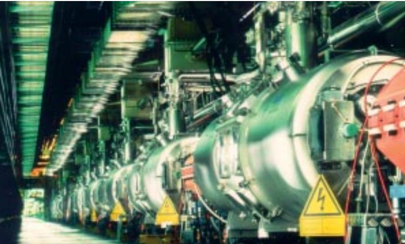
Im HERA-Tunnel: die supraleitenden Resonatoren des Elektronenrings.
