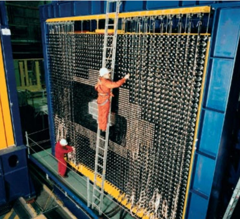
**5 Meter hoch und 6 Meter breit: das elektromagnetische Kalorimeter von HERA-B, in dem die Teilchen gestoppt und nachgewiesen werden.**
